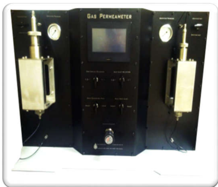
دستگاه اندازه گیری تراوایی با گاز ( آموزشی و تحقیقاتی)
